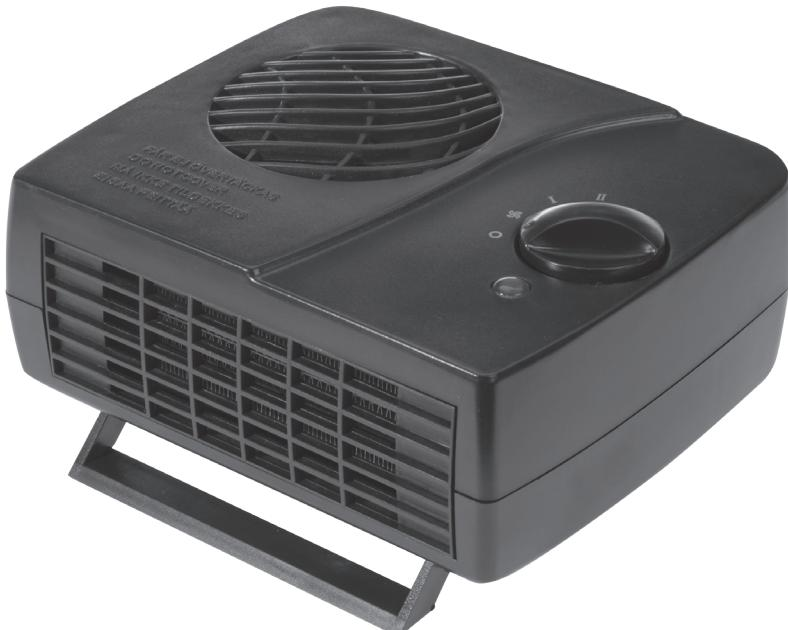
Tämä lämmitin on varustettu keraamisella lämpöelementillä sekä PTC-termistorilla, joka säättää laitteen tehoa automaattisesti ympäröivän ilman lämpötilan mukaan. Lämmittimessä on kaksinkertainen ylikuumenemissuoja ja kaatumissulake, joka katkaisee virran laitteen kaatuessa.
