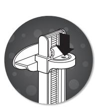
Щоб зняти пристriй iз пiдставки, натиснiть на важiль розблокування на заднiй сторонi затискача пiдставки для пристrою, посуньте затискач угору та знятiть його зi стiйки пiдставки для пристrою.
