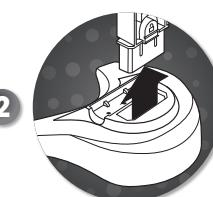
Vajutage statiivi posti alusel olevat vabastushooba ja tõstke statiivi post üles, et eemaldada see aluse küljest.
