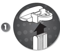
1 Натиснiть на важiль розблокування на заднiй сторонi затискача пiдставки для пристrою, посуньте затискач угору та знятiть його зi стiйки пiдставки для пристrою.
