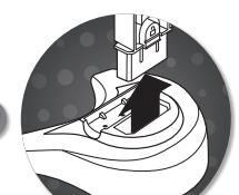
1 Nospied atbrīvošanas sviru ierīces statīva fiksatora aizmugurē un velc fiksatoru augšup, lai to noņemtu no statīva balsta.
