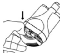
Udskift filteret (5) og filterdækslet (6).
