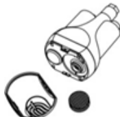
Puhastage filtri võrku (5) ja filtri katet (6).
