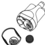
Rengør filteret (5) og filterdækslet (6).
