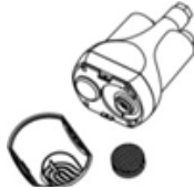
Puhdista suodatinverkko (5) ja suodattimen suojus (6).
