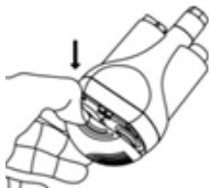
Ersetzen Sie das Filternetz (5) und die Filterabdeckung (6).
