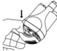
Aseta suodatinverkko (5) ja suodattimen suojus (6) takaisin paikoilleen.
