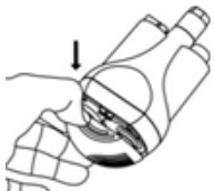
Vėl įdėkite tinklinį filtrą (5) ir uždėkite filtro dangtelį (6).
