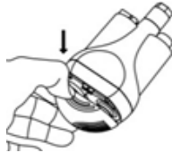
Irrota suodattimen suojus (6).
