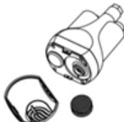
Reinigen Sie das Filternetz (5) und die Filterabdeckung (6).
