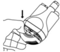
Skift ut filternettet (5) og filterdekselet (6).
