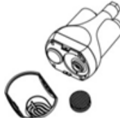
Rengjør filternettet (5) og filterdekselet (6).
