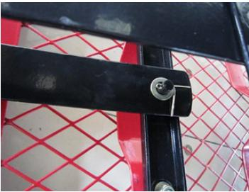
3. Anbring den ene ende af forakselbeslaget (11) på bunden (1) og den anden under gaffelbeslaget (13). Ret hullerne i forakselbeslaget (10), gaffelbeslaget (13) og forakselstiveren (11), indsæt derefter M8x25-bolten fra undersiden, og fastgør delene til hinanden med M8-spændeskiven og M8-møtrikken (17).
