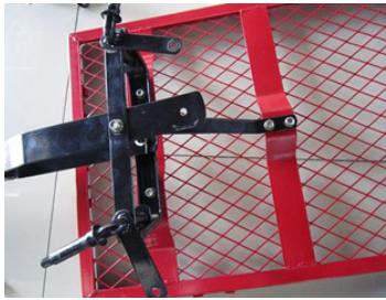
4. Placera styrningens mellanstöd (12) ovanpå framaxelstödet (10) och gaffelfästet (13), placera hålen mot varandra och fäst delarna i varandra med tre M8x18-bultar, M8-brickor och M8-muttrar (16).
