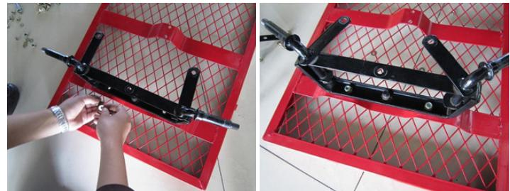
2. Irrota M11-aluslevy ja sokka (19) etuakselin tuessa (10) olevasta pulista. Aseta haarukkakiinnitin (13) etuakselin tuen (10) alaosaa vasten siten, että etuakselin tuessa (10) oleva pultti menee haarukkakiinnittimessä (13) olevan reiän läpi, ja kiinnitä osat toisiinsa M11-aluslevyllä ja sokalla (19).
