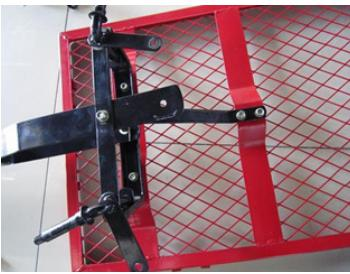
4. Aseta ohjauksen välituki (12) etuakselin tuen (10) ja haarukkakiinnittimen (13) päälle, aseta reiät kohdakkain ja kiinnitä osat toisiinsa kolmella M8x18-pultilla, M8-aluslevyllä ja M8-mutterilla (16).
