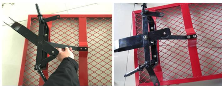
4. Umieścić wspornik dyszla (12) na wsporniku przedniej osi (10) i wsporniku widelca (13), wyrównać otwory i połączyć części ze sobą za pomocą trzech śrub M8x18, podkładek M8 i nakrętek M8 (16).
