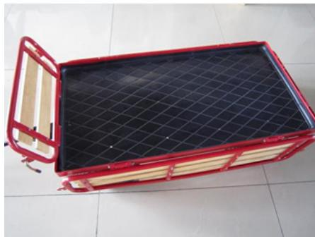
5. Lyft vänstra sidopanelen (2) och bakpanelen (5) i upprätt läge och vänd bakpanelens (5) låshandtag så att det sitter fast hårt i gångjärnet i vänstra sidopanelens (2) hörn.
