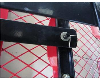
3. Aseta etuakselin kannattimen (11) toinen pää pohjan (1) päälle ja toinen pää haarukkakiinnittimen (13) alle. Aseta etuakselin tuessa (10), haarukkakiinnittimessä (13) ja etuakselin kannattimessa (11) olevat reiät kohdakkain, vie M8x25-pultti alapuolelta reikien läpi ja kiinnitä osat toisiinsa M8-aluslevyllä ja M8-mutterilla (17). Kiinnitä sen jälkeen etuakselin kannattimen (11) toinen pää paikalleen kahdella M8x18-pultilla, M8-aluslevyllä ja M8-mutterilla (16).
