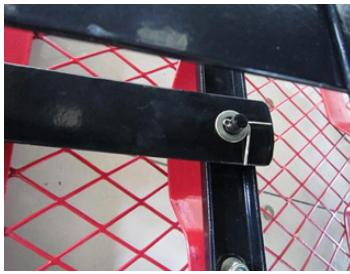
3. Plasser den ene enden av forakselavstiveren (11) på sokkelen (1) og den andre under gaffelbraketten (13). Innrett hullene på forakselstøtten (10), gaffelbraketten (13) og forakselavstiveren (11), sett inn M8 x 25-bolten fra undersiden, og fest delene sammen med M8-skiven og M8-mutteren (17).
