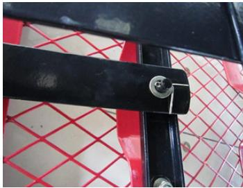
3. Placera framaxelbalkens (11) andra ände ovanpå bottnen (1) och den andra änden under gaffelfästet (13). Placera hålen i framaxelstödet (10), gaffelfästet (13) och framaxelbalken (11) mot varandra, för M8x25-bulten igenom hålen underifrån och fäst delarna i varandra med M8-brickan och M8-muttern (17).
