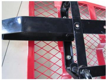
3. Platzieren Sie ein Ende der Vorderachsstrebe (11) am Sockel (1) und das andere Ende unter der Gabelhalterung (13). Richten Sie die Löcher am Vorderachsträger (10), der Gabelhalterung (13) und der Vorderachsstrebe (11) aus, setzen Sie dann die M8x25-Schraube von unten ein und befestigen Sie die Teile zusammen mit der M8-Unterlegscheibe und der M8-Mutter (17).
