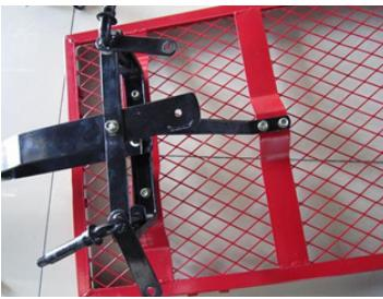
4. Anbring styreamnen (12) på forakselbeslaget (10) og gaffelbeslaget (13), ret hullerne ind, og fastgør delene til hinanden med tre M8x18-bolte, M8-spændeskiver og M8-møtrikker (16).
