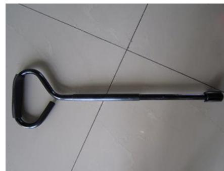
2. Setzen Sie den Ziehgriff (15) und die Kunststoffkupplung (14) in die Gabelhalterung (13) ein.
