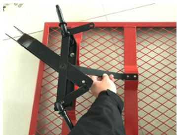
4. Platzieren Sie die Lenkstrebe (12) am Vorderachsträger (10) und der Gabelhalterung (13), richten Sie die Löcher aus und befestigen Sie die Teile mit drei M8x18-Schrauben, M8-Unterlegscheiben und M8-Muttern (16).
