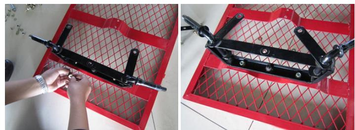
2. Entfernen Sie die M11-Unterlegscheibe und den Stift (19) von der Schraube am Vorderachsträger (10). Platzieren Sie die Gabelhalterung (13) am unteren Teil des Vorderachsträgers (10), sodass die Schraube am Vorderachsträger (10) in das Loch am Gabelträger (13) passt, und befestigen Sie die Teile zusammen mit der M11-Unterlegscheibe und dem Stift (19).
